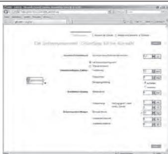
高額な費用がかかる実テストに代わる、最適な空気圧シミュレーションを提供します。このツールは、空気圧制御の配線・配管全体の選定とコンフィグレーションをサポートする専門システムです。1つのパラメータを変更すると、他のパラメータはシミュレーションプログラムによって自動的に整合性が取られます。
